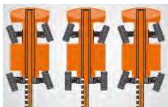
Рулевое управление на четыре колеса
