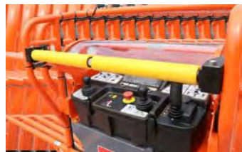
Система защиты от заземления
